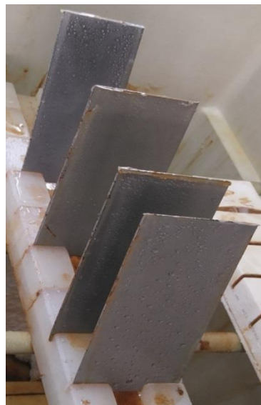
Hình 2. Bề mặt các mẫu thử nghiệm mù muối.
